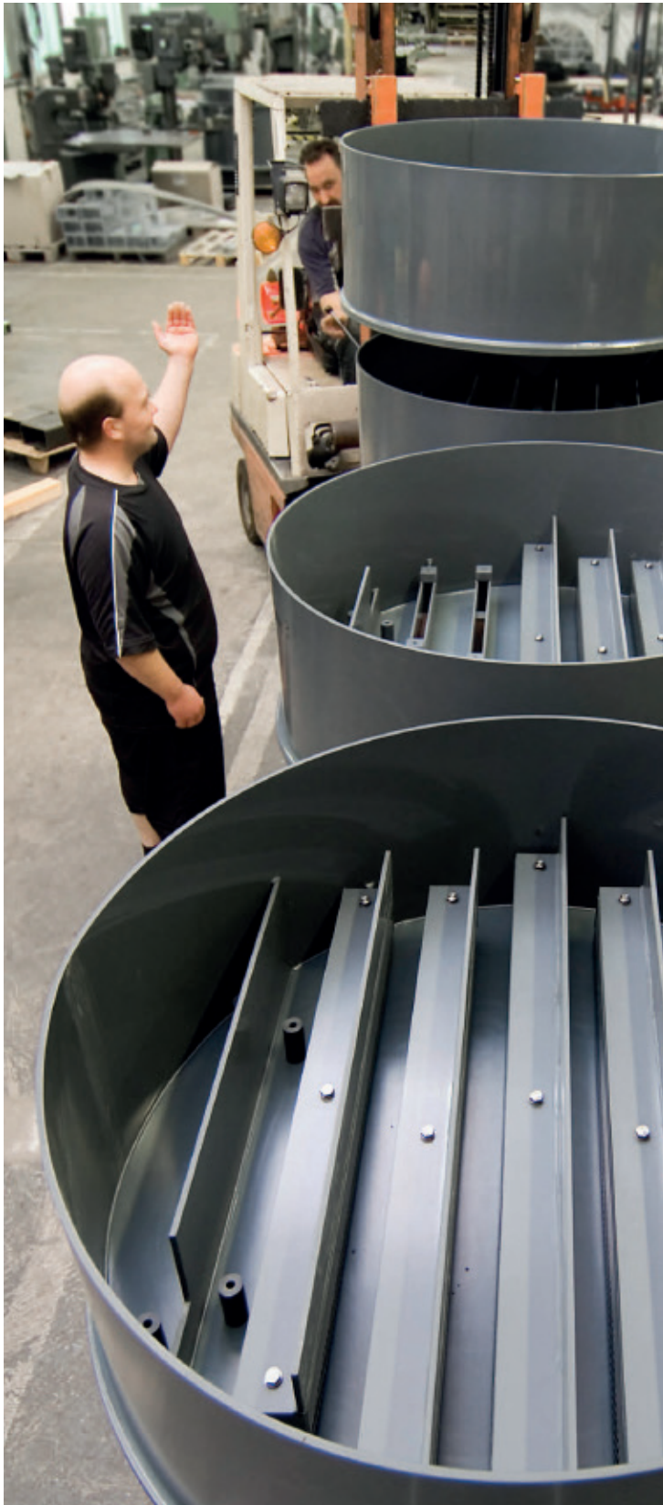
Tunnelböden Tunnel trays
