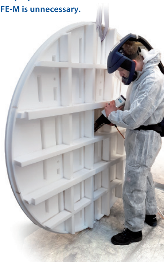
Stoffaustauschboden mit aufgeschweißter Rippenkonstruktion zur Stabilisierung. Boden aus 30 mm starker Platte. Mass transfer tray with welded rib construction for stabilization. Bottom made of 30 mm thick plate.
